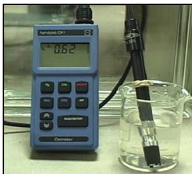
Figura 5. Dispositivo electrónico para determinar la cantidad de oxígeno disuelto en el agua (Oxigenómetro)
